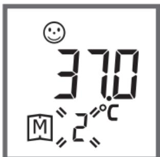
Si la mémoire est pleine, le résultat le plus ancien est supprimé et remplacé par le plus récent. Quand le dernier enregistrement est affiché sur l'écran LCD, appuyez à nouveau sur le bouton
