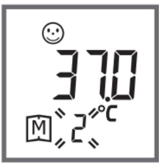
Wenn der Speicher voll ist, wird das älteste Messergebnis mit dem neuesten überschrieben. Wenn das letzte Ergebnis angezeigt wird, beginnt die Anzeige mit einem Druck auf die Ein-/Speichertaste wieder von vorn.
