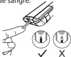
Aproxime su dedo hasta que la gota de sangre entre en contacto con el canal absorbente de la tira reactiva y se absorba automáticamente. Cuando se haya absorbido la sangre y llenado completamente la ventana de confirmación, el dispositivo comenzará la cuenta atrás. No retire el dedo hasta escuchar un pitido.
