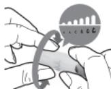
6. Ziehen Sie den Spannregler heraus, bis der orangefarbene Stab im Fenster der Auslösetaste erscheint.
