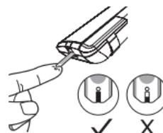
Colocar o dedo de forma a que a gota de sangue entre em contacto com o orifício absorvente da tira-teste e a gota será automaticamente absorvida pela tira. Retirar o dedo até a janela de confirmação ficar totalmente preenchida. O aparelho iniciará a contagem decrescente. Não retirar o dedo até ouvir o sinal sonoro.
